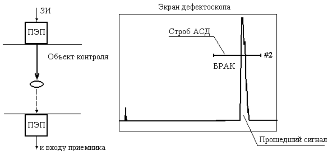
Рис. 4.9.2. Работа автоматического сигнализатора дефектов для теневого метода.
